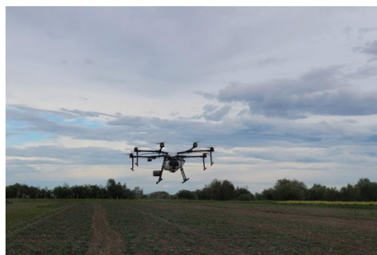
Зураг 2-75, 76. DJI MG-1P дроноор талбайд үйлдвэрлэлийн шүршилт хийгдэв
