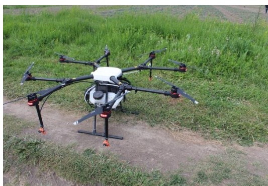
Зураг 2-75, 76. DJI MG-1P дроноор талбайд үйлдвэрлэлийн шүршилт хийгдэв
